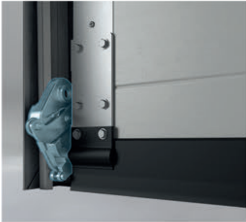
Sikkerhedsbremsen forhindrer dørfløjen i at falde ned i tilfælde af kabelskader
